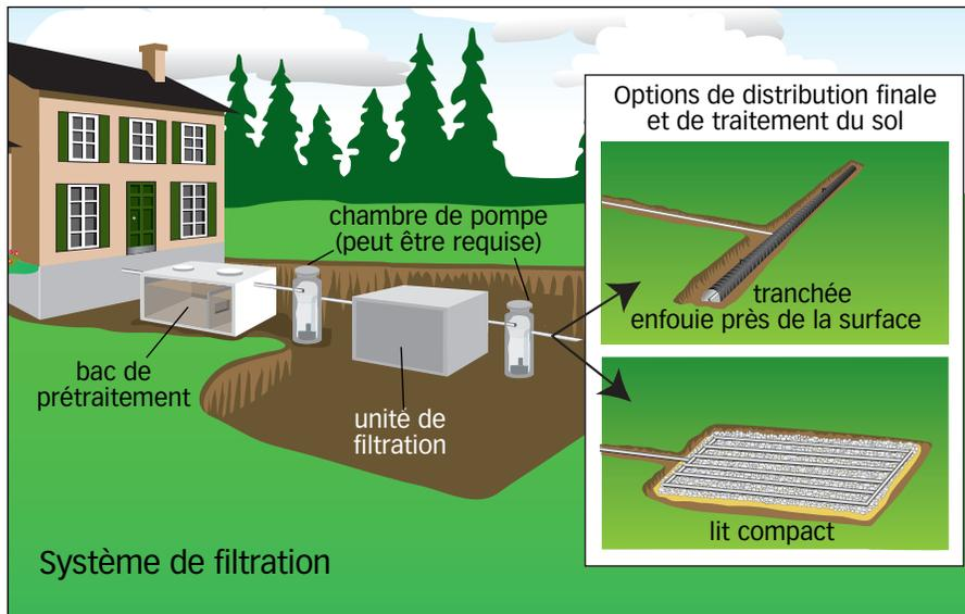
L'effluent provenant d'une unité de filtration peut être redistribué dans le sol indigène à l'aide d'une tranchée enfouie près de la surface ou d'un lit compact.
