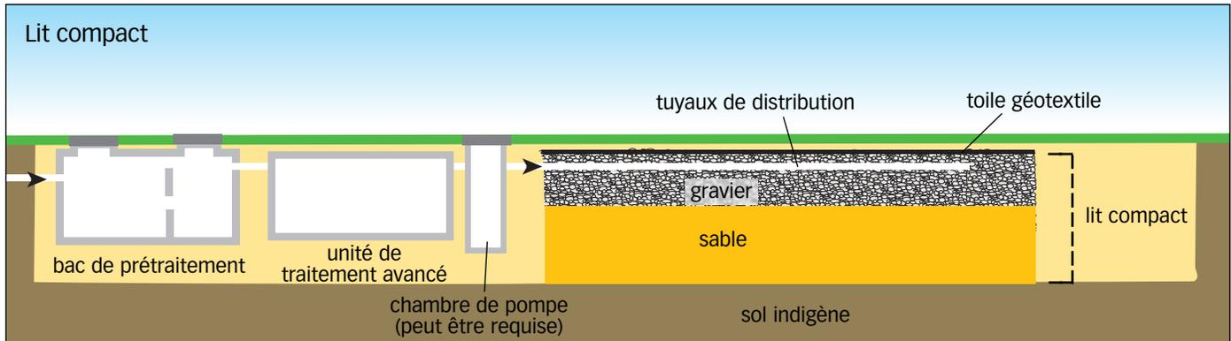
Vue latérale d'un lit compact suivant une unité de traitement avancé. Nota : certains modèles de système permettent à l'unité de traitement d'être placée sur le dessus du lit compact.
