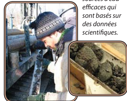
Forage pour récupérer des carottes d'échantillon permettant de déterminer la composition de l'esker.
